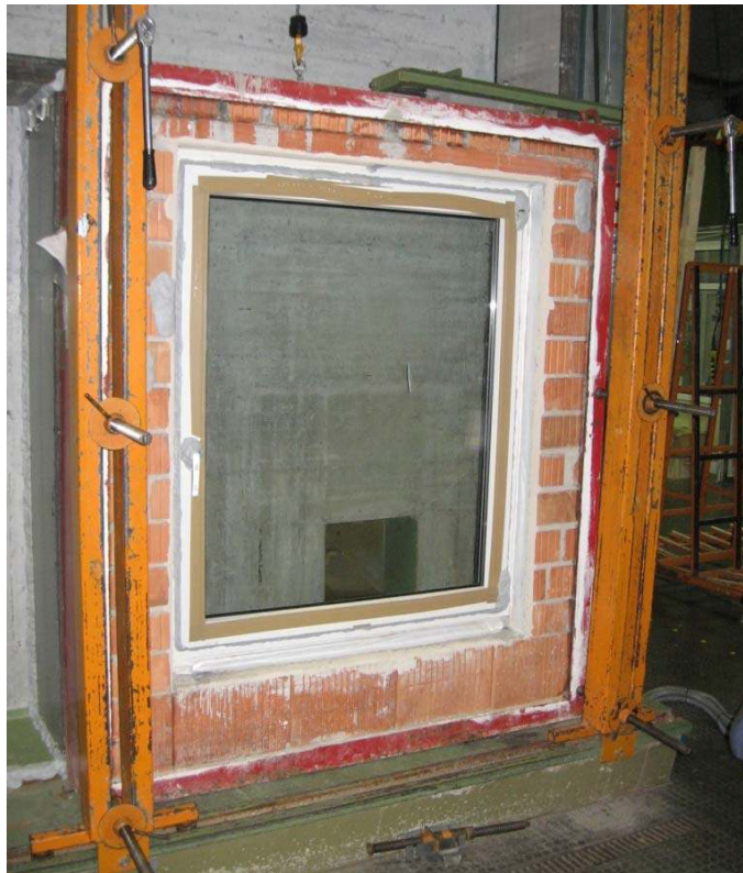
Bild 1 Probekörper aufgebaut auf dem Fensterprüfstand
